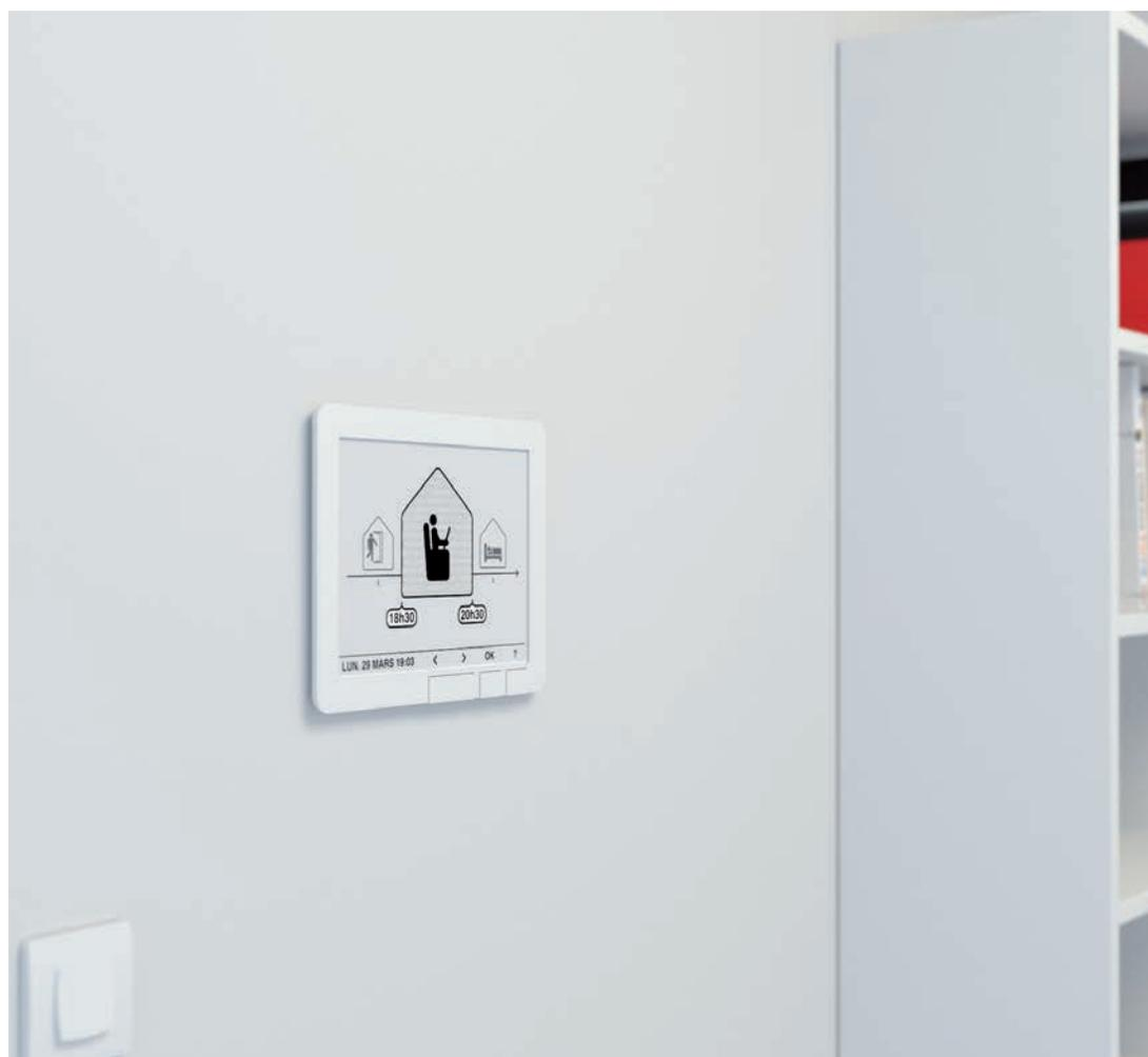
L'interface de pilotage par les usages peut prendre la forme d'une station murale qui fonctionne suivant la technologie e-ink (papier électronique). Ce type de technologie permet d'afficher du texte et des images indéfiniment, sans consommer d'énergie en mode affichage seulement lorsque le contenu affiché est modifié.
